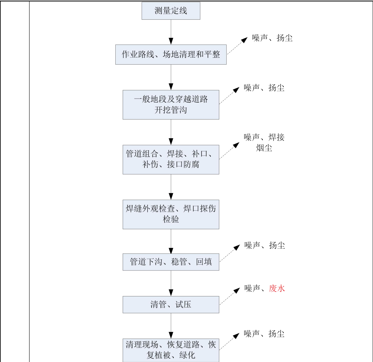
图 2-1 管网铺设施工工艺及产物节点图
